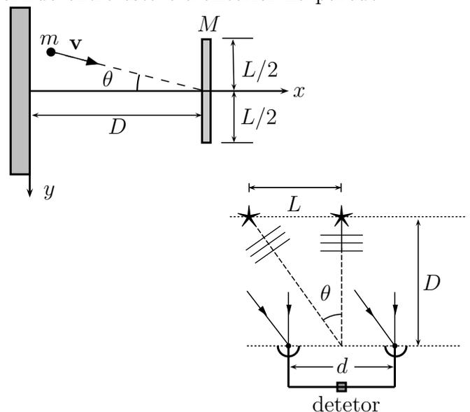
**Questão 24.** Dois radiotelescópios num mesmo plano com duas estrelas operam como um interferômetro na frequência de 2,1 GHz. As estrelas são interdistantes de  $L = 5,0$  anos-luz e situam-se a uma distância  $D = 2,5 \times 10^7$  anos-luz da Terra. Ver figura. Calcule a separação mínima,  $d$ , entre os dois radiotelescópios necessária para distinguir as estrelas. Sendo  $\theta \ll 1$  em radianos, use a aproximação  $\theta \simeq \tan \theta \simeq \sin \theta$ .
