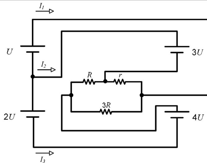
A figura acima apresenta um circuito composto por quatro baterias e três resistores. Sabendo-se que  $I_1$  é igual a  $10 \frac{U}{R}$ , determine, em função de  $U$  e  $R$ :
