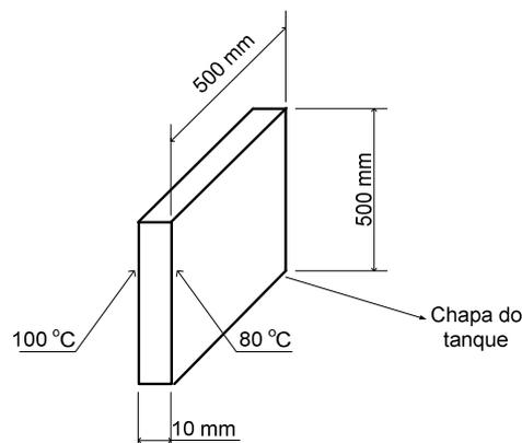
**Experiência 2:** A chapa da experiência anterior é posta em contato com uma chapa padrão de mesma área de seção reta e espessura 210 mm. Nota-se que, submetendo este conjunto a 50% da taxa de calor empregada no tratamento do resíduo, a temperatura da face livre da chapa padrão é  $60^{\circ}\text{C}$  enquanto que a face livre da chapa da experiência atinge  $100^{\circ}\text{C}$ .
