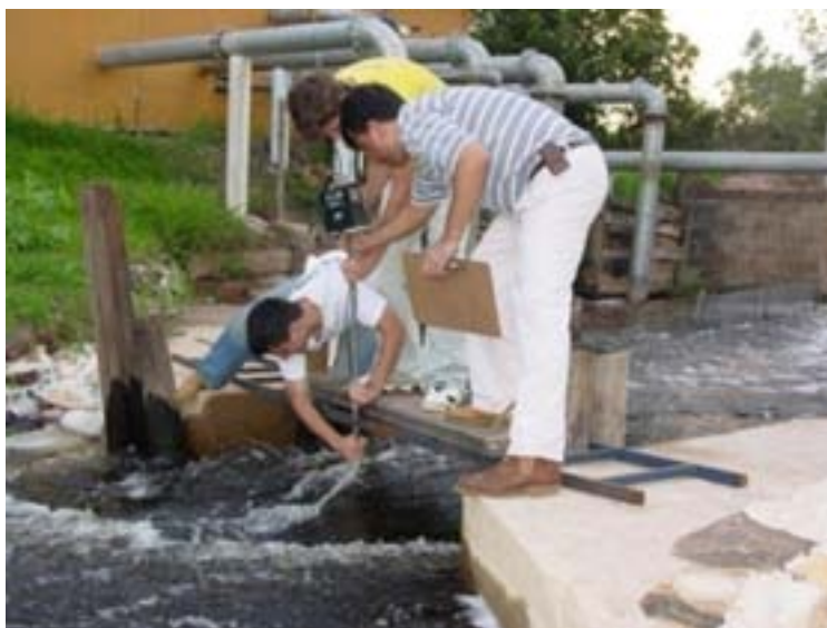
Medição de vazão para cálculo de balanço hídrico em bacia hidrográfica.
